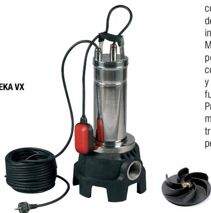
Bomba centrífuga sumergible con rodete vórtex de fundición de acero (rodete de tecnopolímero para Feka VX), adecuada para bombear aguas negras y residuales que contienen sólidos con tamaño máximo de 50 mm.
